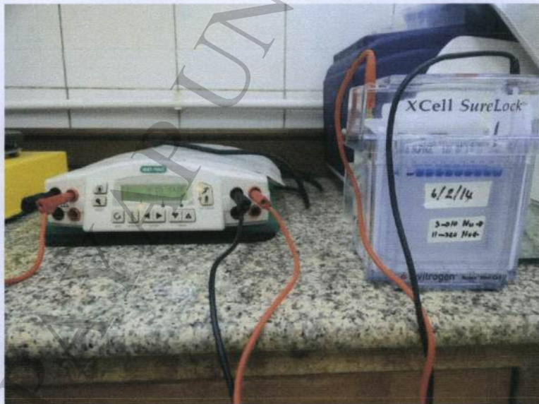
รูปที่ 14 แสดงเครื่องมือตรวจสอบความบริสุทธิ์ของโปรตีนด้วย XCell SureLock Mini cell set
